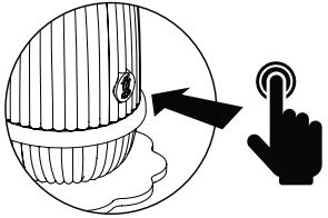
La luz puede graduarse utilizando el propio logo de encendido del módulo LED.
